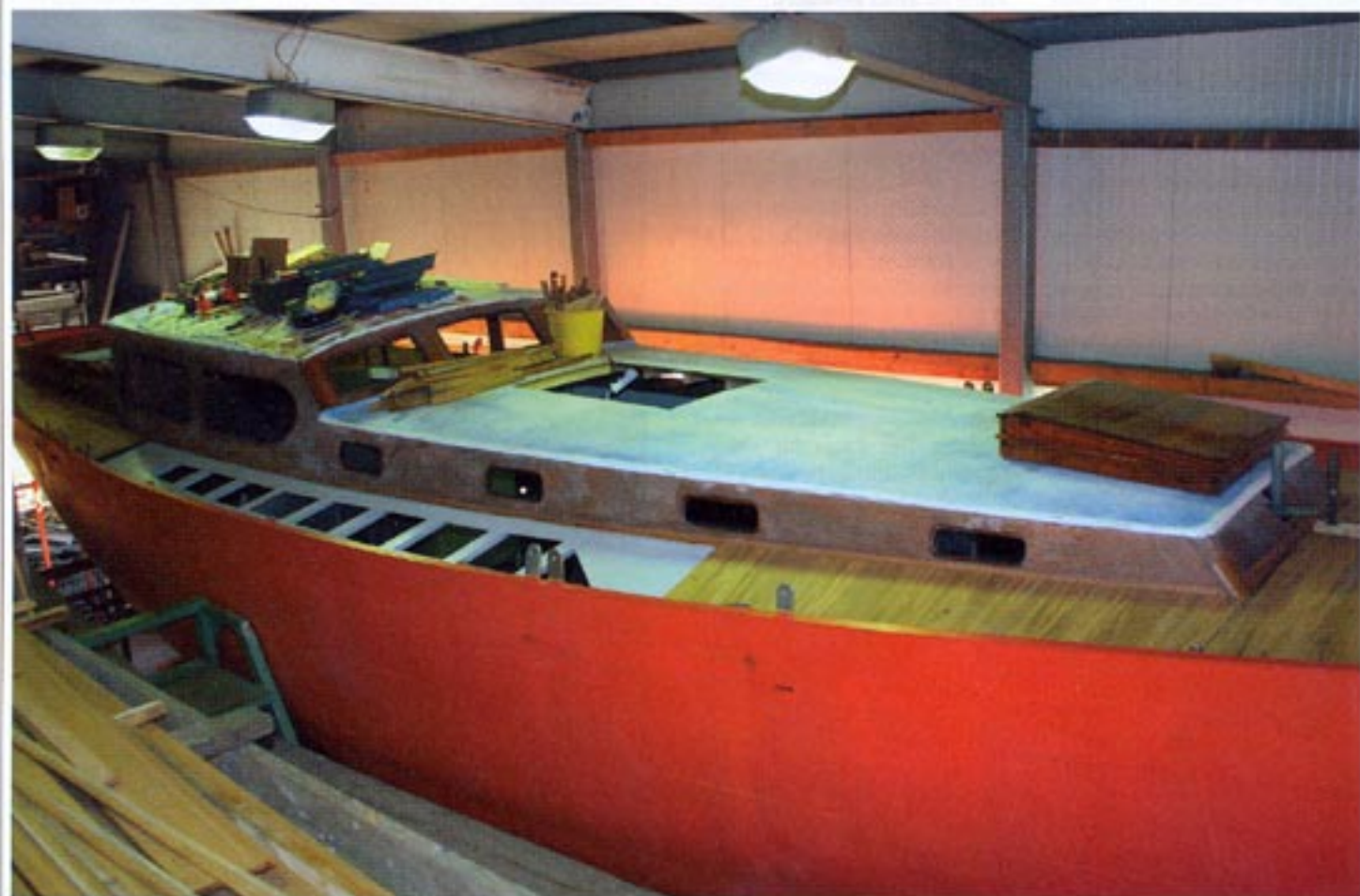
Das Deck der „Safari“ wird ohne Sperrholzplatten aufgebracht. Der Unterbau besteht aus abgesperrtem Teakholz. Der Eigner erhofft sich davon eine bessere Haltbarkeit. Der Verschnitt, der beim Zuschnitt der Teakriemen ohnehin angefallen wäre, kann dafür benutzt werden. Dadurch müssen keine Kompromisse bei der Nutzschrift eingegangen werden.
